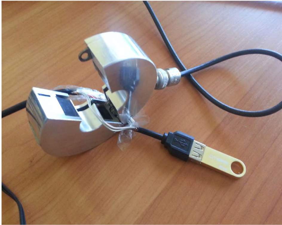
Рисунок 2.15 - Підключення струмознімача до USB-інтерфейсу
