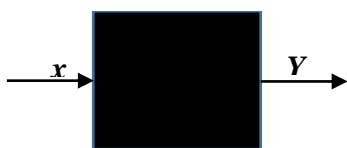
Рисунок 4.2 – Подання досліджуваної системи у вигляді «чорного ящика» (один фактор, один відгук)
