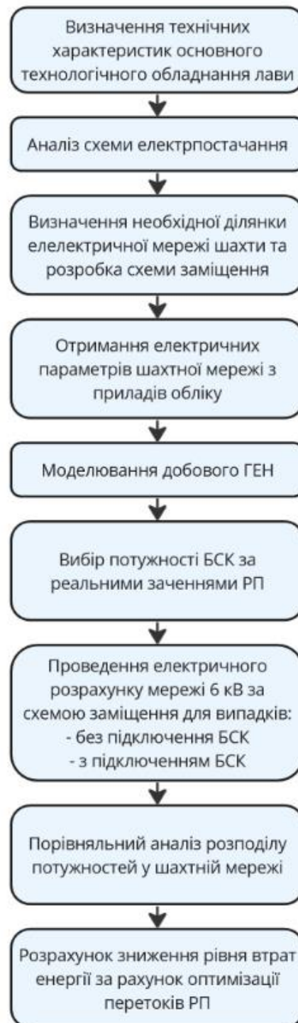
Рисунок 7.1. Алгоритм моделювання оптимальних перетоків РП в підземних шахтних мережах
