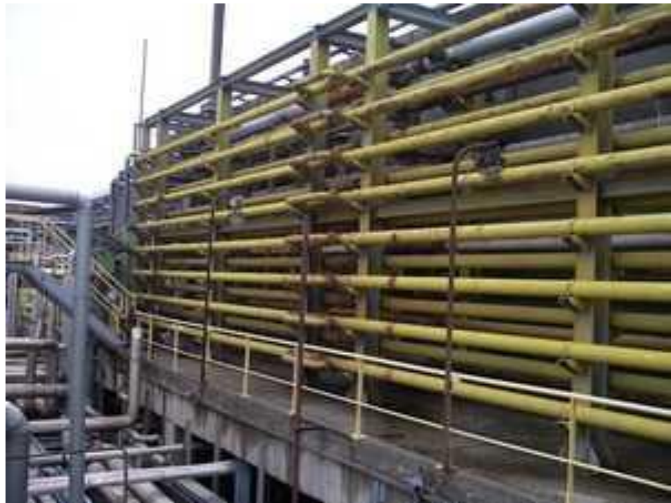
Рисунок 1.3 - Холодильник зворотного етилену проміжного тиску серії КАЕ-250-300
