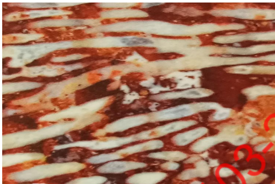
Рисунок 3.33 – Структура коралового вапняку з гнізподібними вкрапленнями халцедону усередині кальцитових агрегатів.
