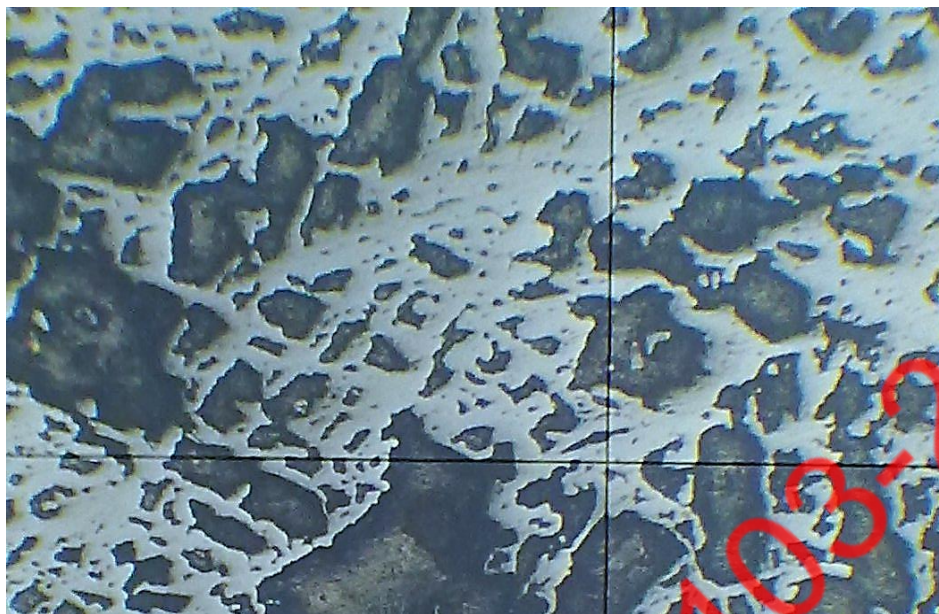
Рисунок 3.31 – Петельчаста мікроструктура гетит-гідрогетитових агрегатів. Світло відбите, ніколі II, зб.90.
