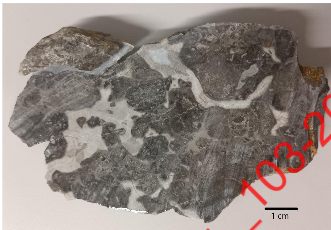
Рисунок 3.9 – Зразок V13 рифових фацій у формації Wetterstein на півночі
