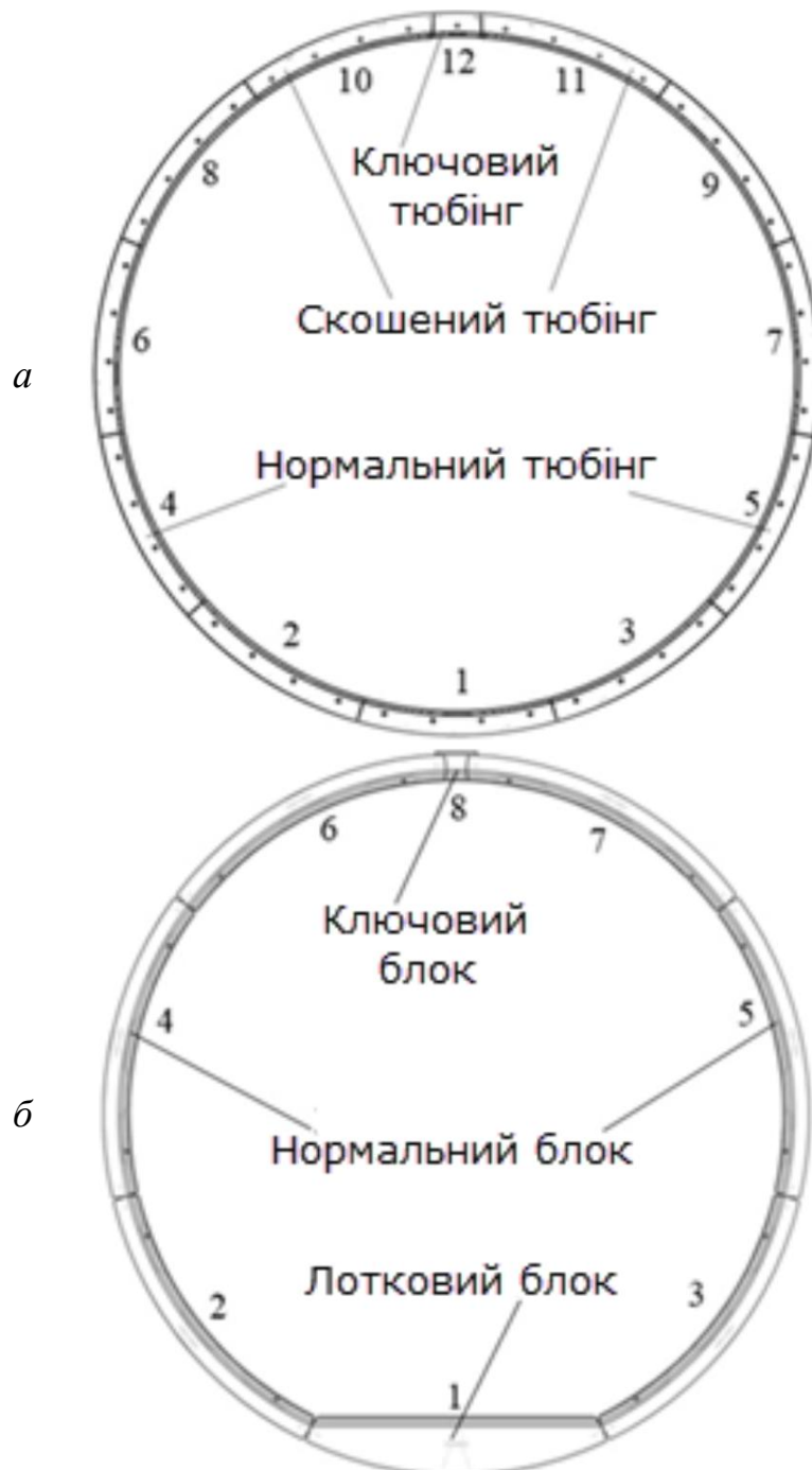
Рис. 1.10. Види і схеми установки тунельної оправи: а – тюрбінгова оправа; б – блокова оправа
