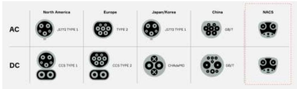
Рис. 1.5. Типи роз'ємів для заряду електромобілів
