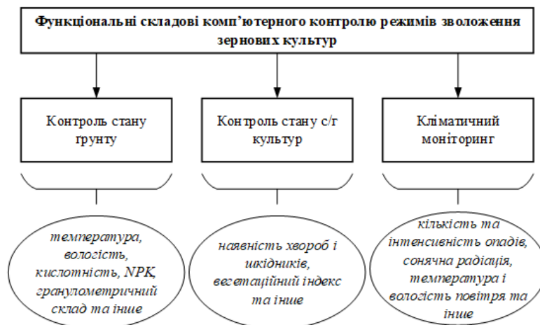
Рис. 2. Основні техніко-функціональні складові процесу адаптивного комп’ютерного контролю стану с/г об’єктів рослинництва під час оптимізації режимів зрошення ґрунту
