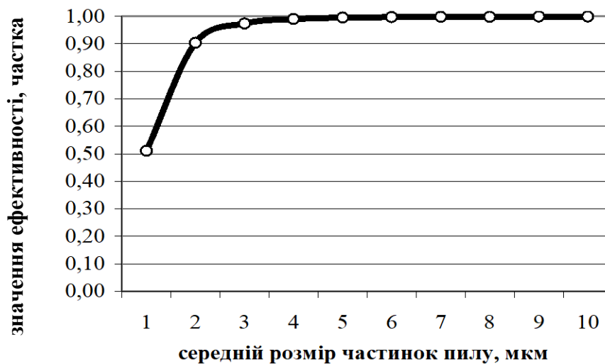
Рис. 3.1 – Приклад побудови графіка залежності ефективності очищення газу у відцентровому циклоні обраного типу від фракційного складу пилу
