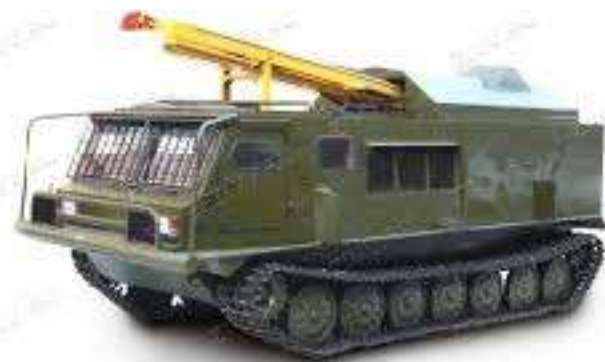
Бурова установка на гусеничному ходу УРБ-2А2
