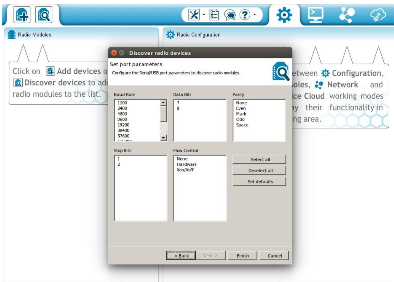
Рисунок 3.2 - Приєднання модемів ZigBee до USB порта
