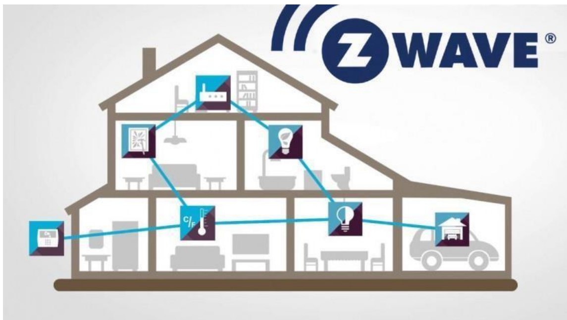
Рисунок 1.2 – Приклад побудови мережі розумного будинку за допомогою стандарту Z-Wave
