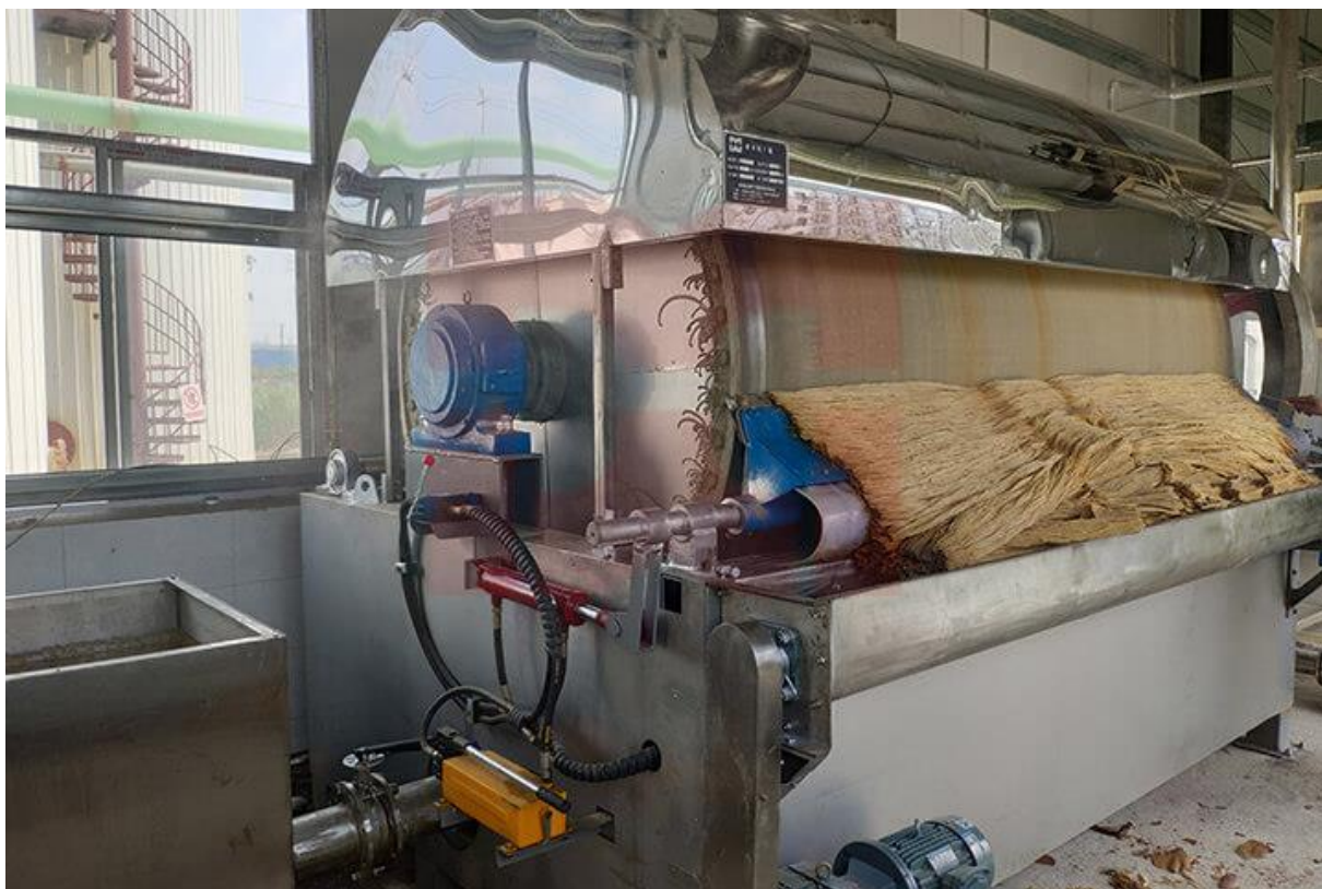
Рисунок 1.4 - Барабанна дріжджова сушарка Jiutian JHD2500×3000
