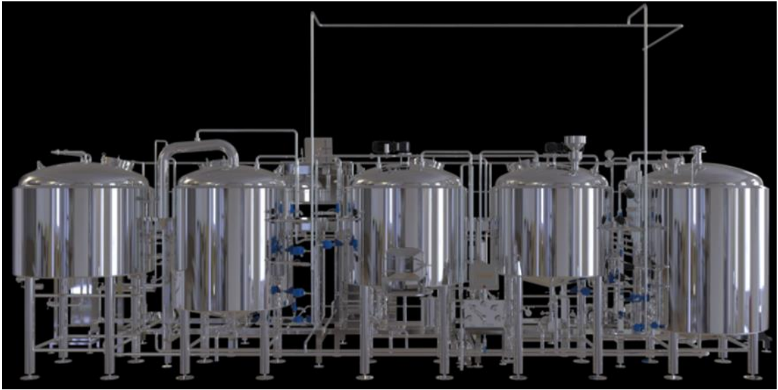
Рисунок 1.3 – Технологічна лінія розмноження дріжджів
