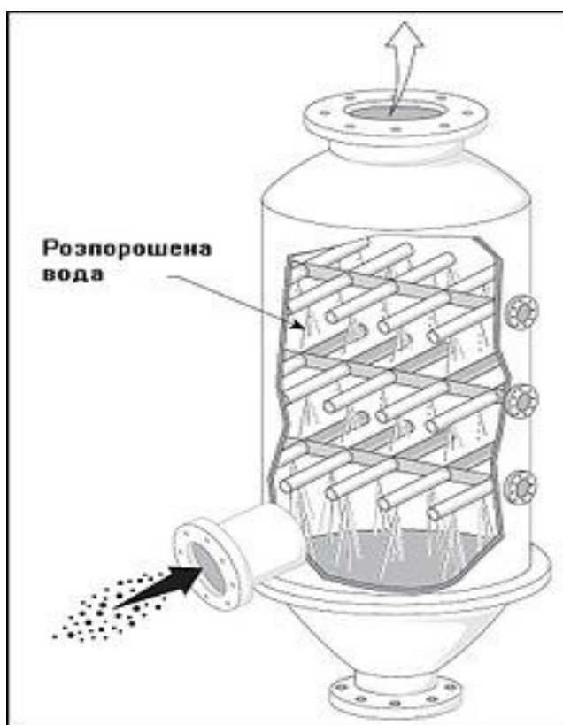
Рисунок 2.3. – Порожнистий скрубер і схема подачі в нього води
