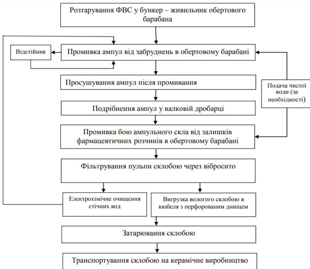
Рисунок 2.5– Схема підготовки ампул для утилізації у виробництві керамічної плитки
