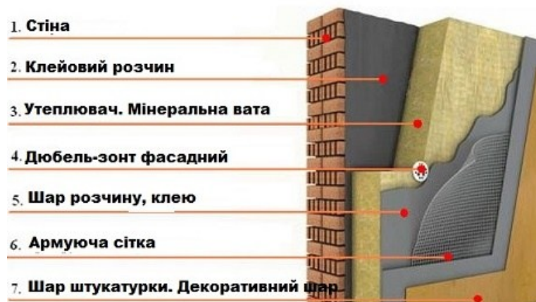
Рисунок 3.2 – Схема утеплення фасаду мінеральною ватою
