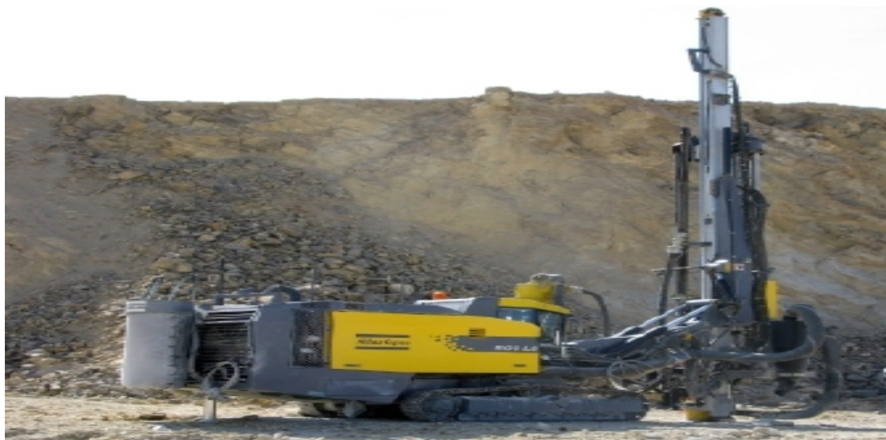
Рисунок 2.4. Буровий станок Atlas Copco PV-275 з діаметром долота 200 мм.
