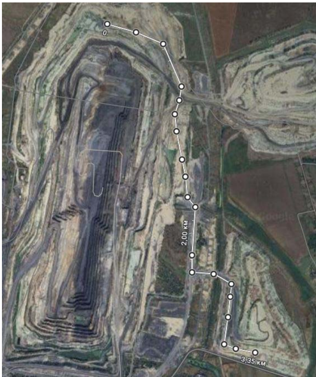
Рисунок 2.3 - Схеми розміщення транспортних шляхів під час доставки від вибою №3 : а – відвальний майданчик №1; б – відвальний майданчик №2; в – відвальний майданчик №3
