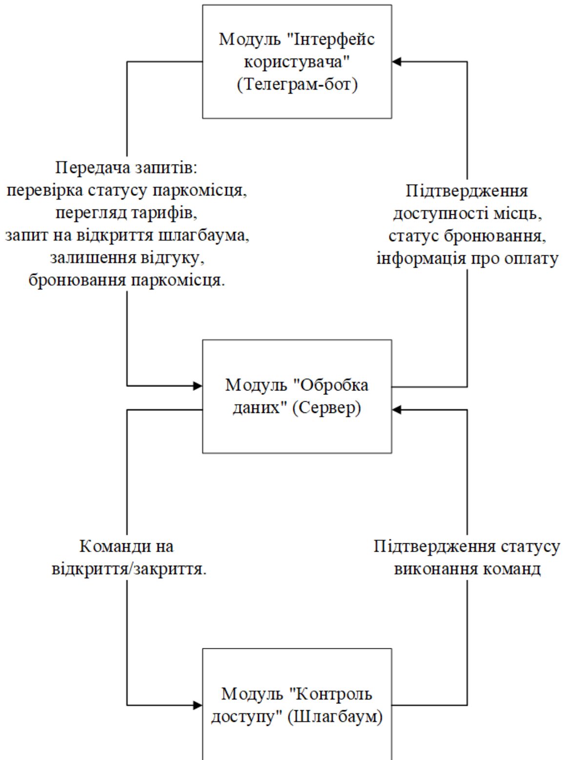
Рисунок 3.1 – Функціональна схема автоматизованого управління паркуванням
