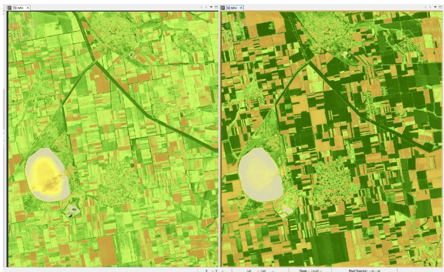
Рисунок 3.5 – Аналіз зображень в SNAP за 2023 та 2021 роки (вегетаційний індекс: канали B04, B8)
