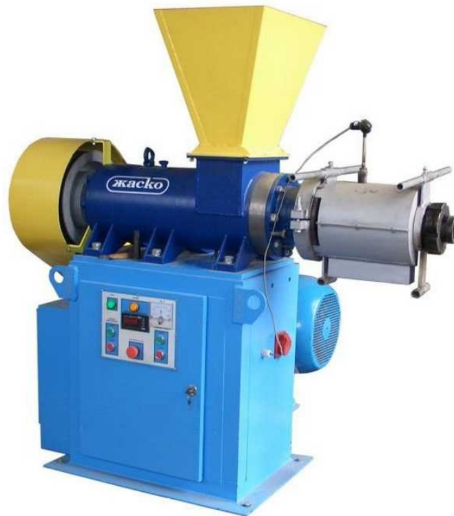
Рисунок 3.1 – Прес для брикетування
