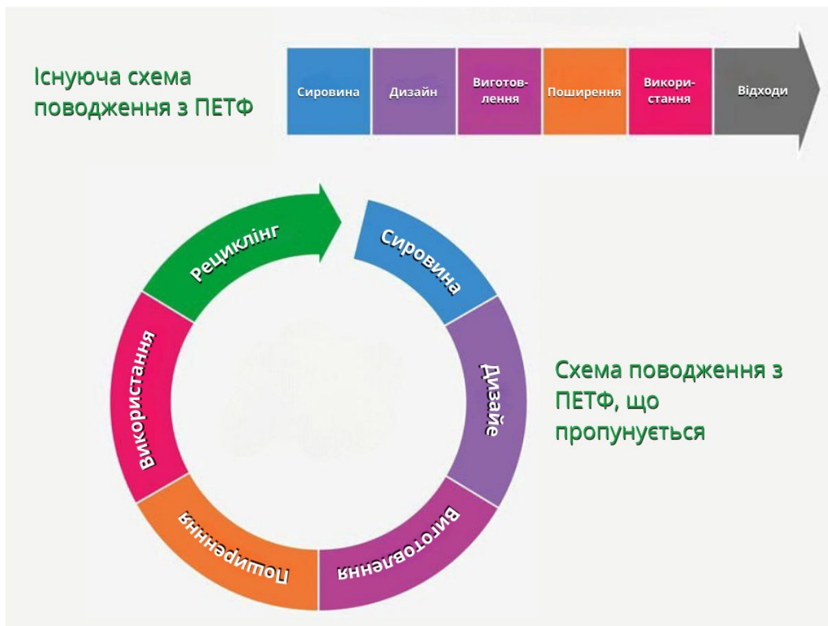
Рисунок 3.6 – Існуюча та запропонована схеми поводження з ПЕТФ
