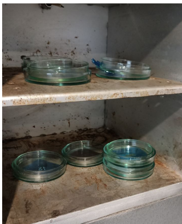
Рисунок 2.13 – Термічна обробка вторинного ПЕТФ в лабораторній електродіжці при температурі 200 °C
