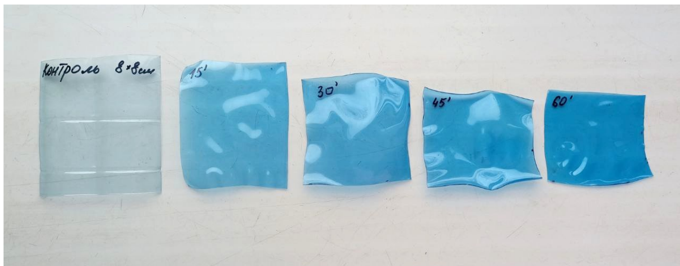
Рисунок 2.17 – Вплив термообробки на вторинний ПЕТФ за різний час
