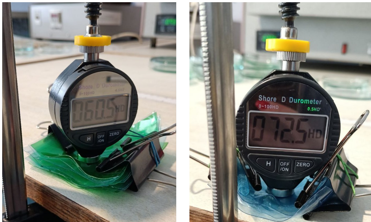
Рисунок 2.14 – Вимірювання дюрOMETром міцності вторинного ПЕТФ після 30 та 45 хвилин термічної обробки при 200°C
