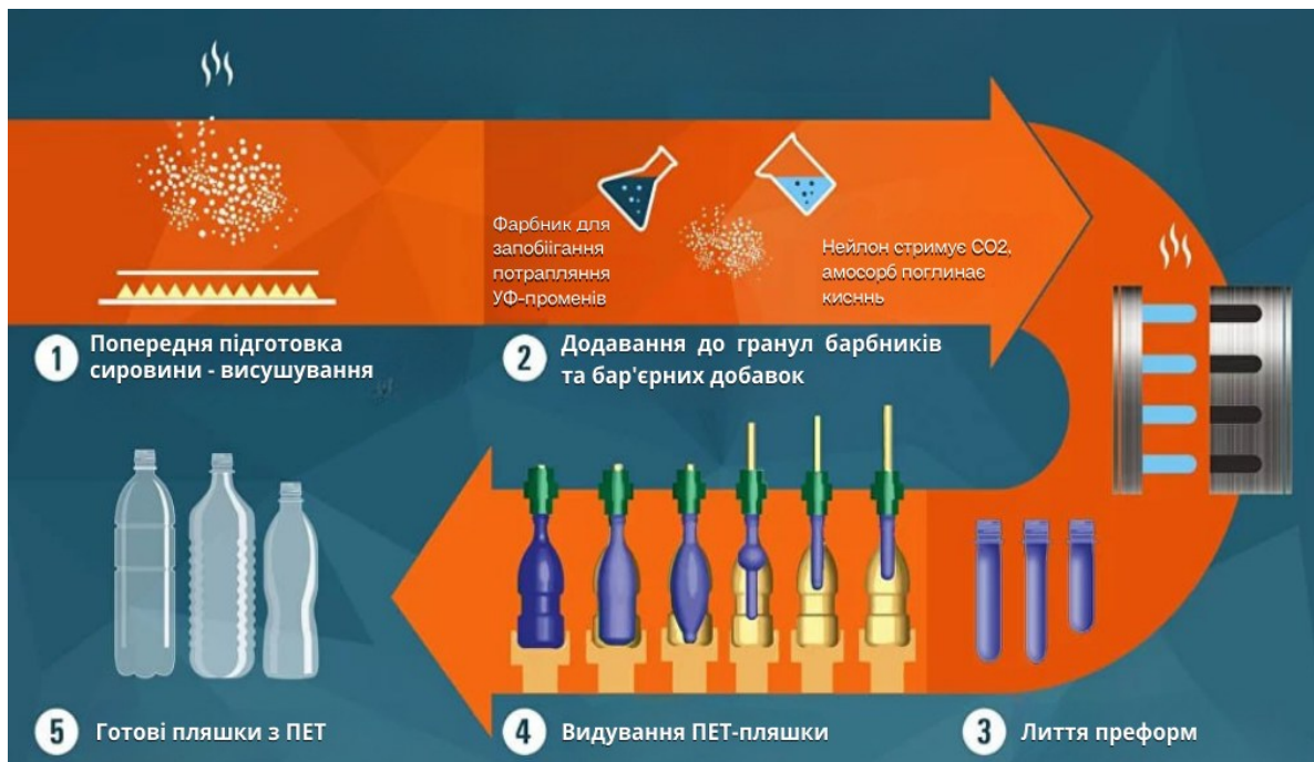
Рисунок 3.3 – Процес виготовлення ПЕТ-пляшки
