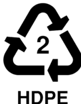
Рисунок 1.4 – Маркування поліетилену високої щільності, PEHD (HDPE)
