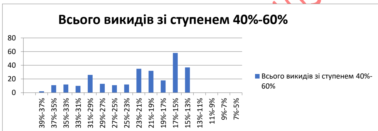
Рисунок 4.9 - Розповсюдження загальної кількості викидів вугілля і газу в залежності від виходу летких речовин ( V^{daf} , %) для вугілля зі ступенем відновленості від 40 до 60%
