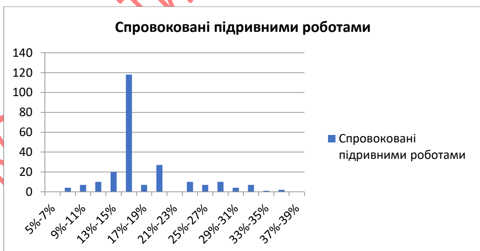
Рисунок 4.4 - Розповсюдження кількості спровокованих викидів вугілля і газу в залежності від виходу летких речовин - V^{daf} , %
