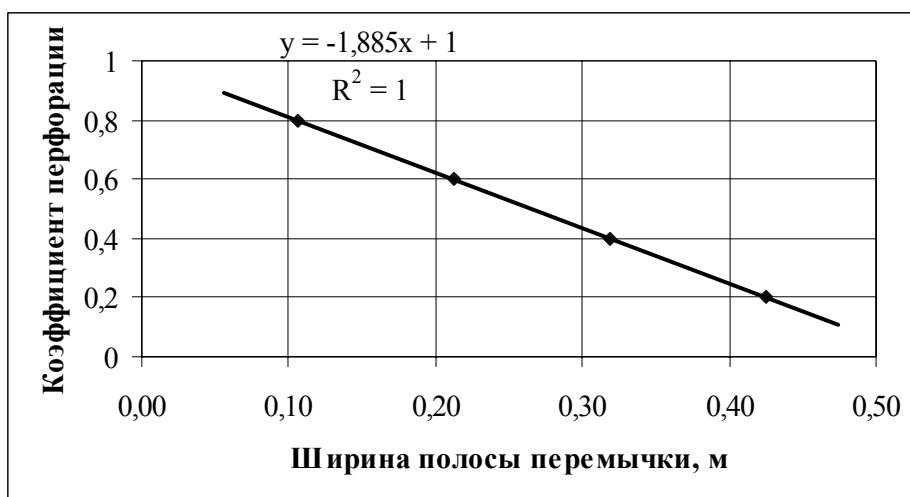
Рис. 3.10. Зависимость степени перфорации перемычки от ширины ленты
