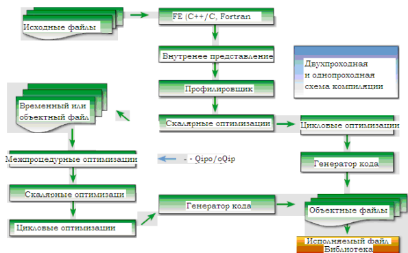
Рисунок 2. Порядок выполнения оптимизаций при однопроходной и двухпроходной схеме компиляции
