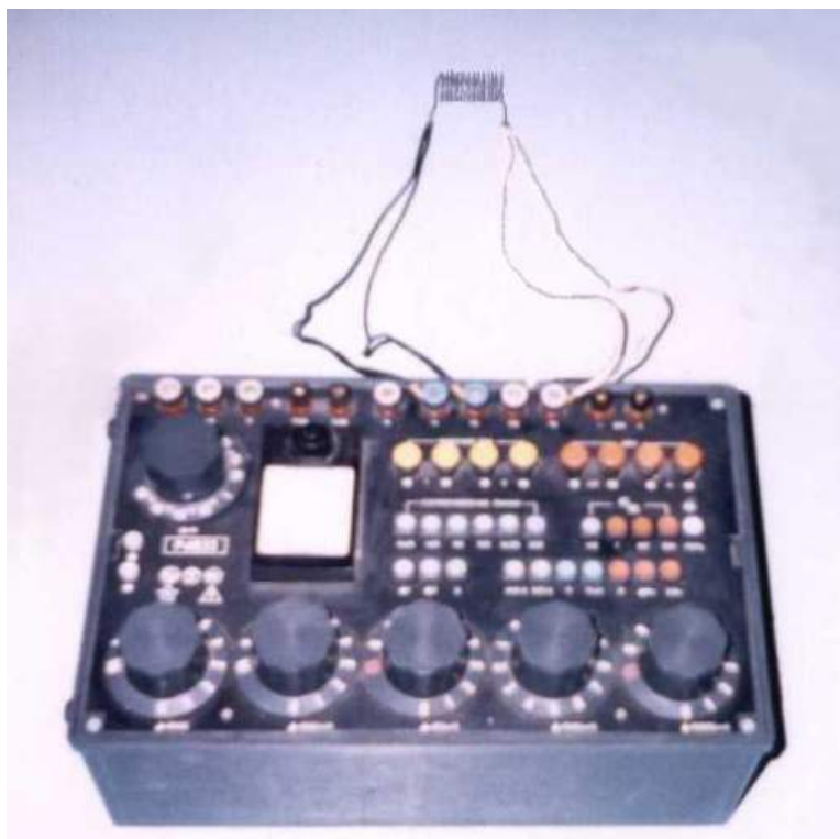
Рис. 4.11. Измерение коррозионного износа металлического оборудования по изменению сопротивления образцов
