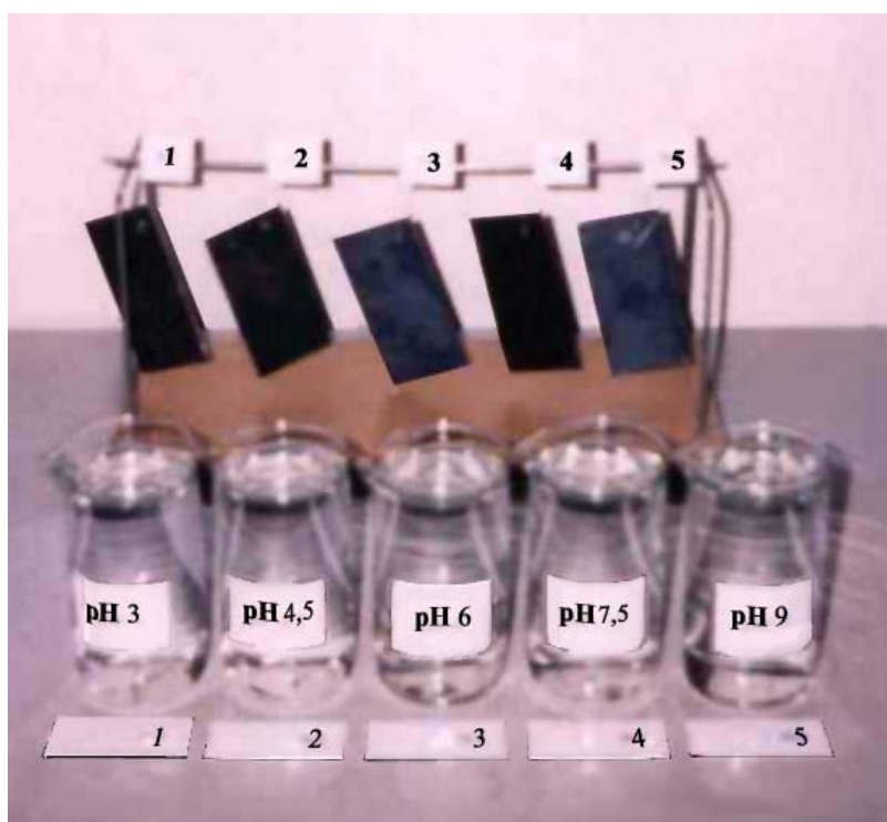
Рис. 2.9. Испытания по определению влияния окалины на коррозию металла в растворах с различным значением pH
