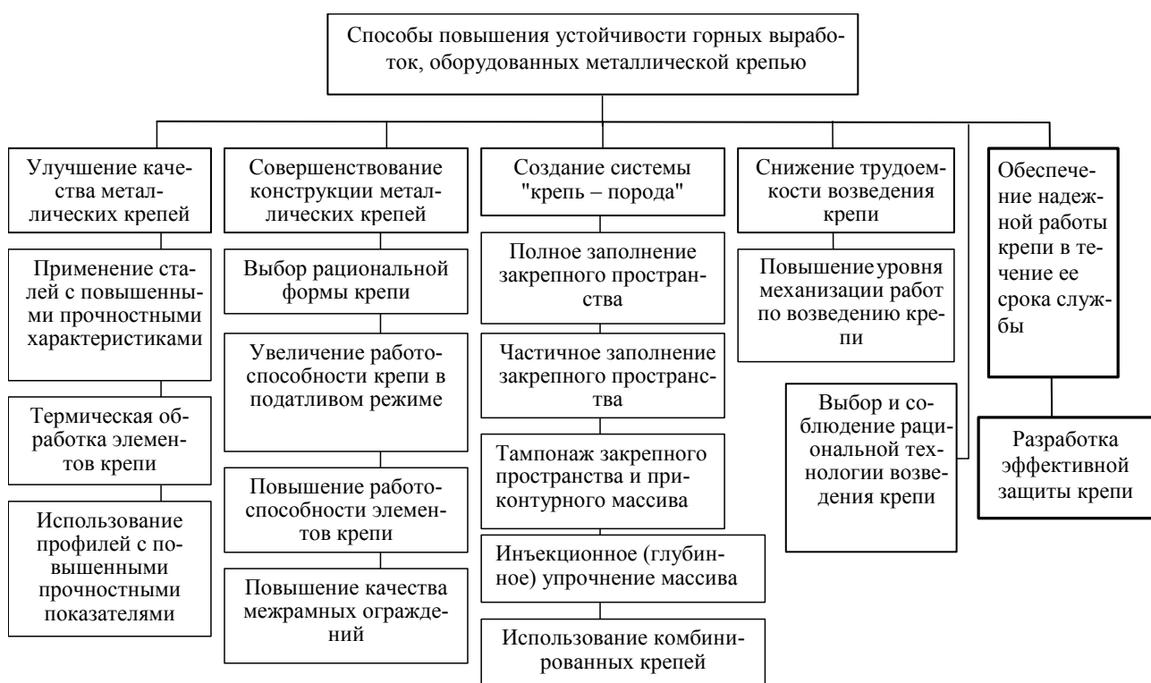
Рис. 1.1. Способы и средства повышения устойчивости выработок
