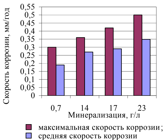
Рис. 2.12. Результаты шахтных наблюдений изменения коррозии металлической арочной крепи в зависимости от минерализации вод
