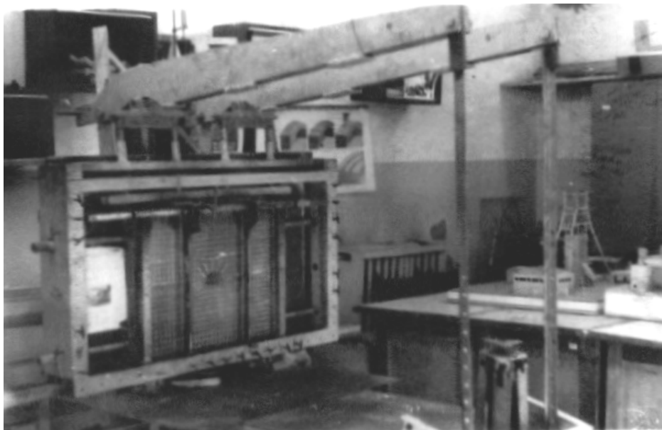
Рис. 3.1. Специальный стенд для плоского моделирования на эквивалентных материалах
