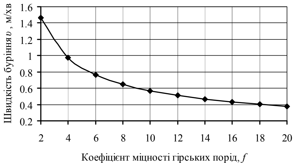
Рис. 1.1. Графік залежності швидкості буріння v від коефіцієнта міцності порід f , для колонкового перфоратора ПК-60М
