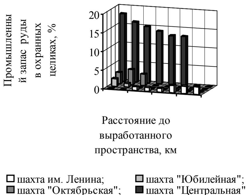
Рис. 1.5. Залегание руд в охранных целиках Криворожского бассейна по отношению к выработанному пространству шахт
