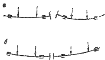
Рис. 2.3.11. Центровка валов: а — неправильно; б — правильно
