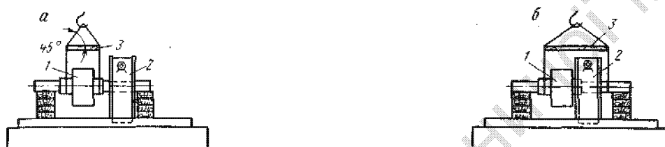
Рис. 2.4.7. Ввод ротора в неразъемный статор у двигателей с удлиненной рамой: а — частичный ввод ротора в статор и укладка его на брусья; б — окончательный ввод ротора: 1 — ротор; 2 — статор; 3 — деревянная распорка
