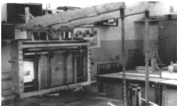
*Рис. 1. Специальный стенд для плоского моделирования на эквивалентных материалах*
