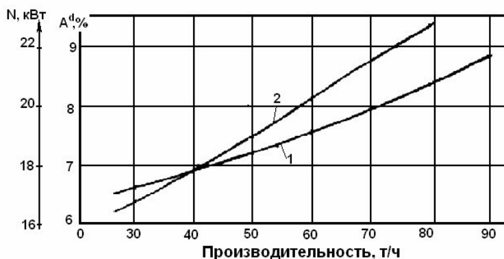
Рис. 2. Зависимость зольности обезвоженного концентрата (1) и мощности, потребляемой центрифугой (2) исходя из нагрузки на центрифугу
