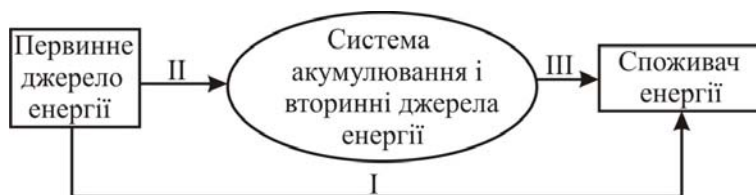
Рисунок 1.42 – Основні компоненти системи автономного енергозбереження
