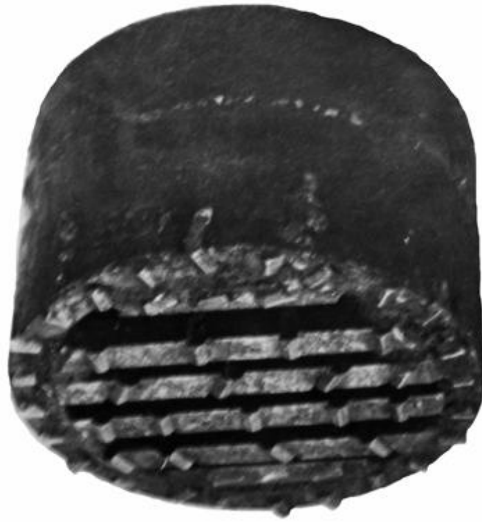
Рис. 4.8 Долово с параллельно расположенными керноломными пластинами
