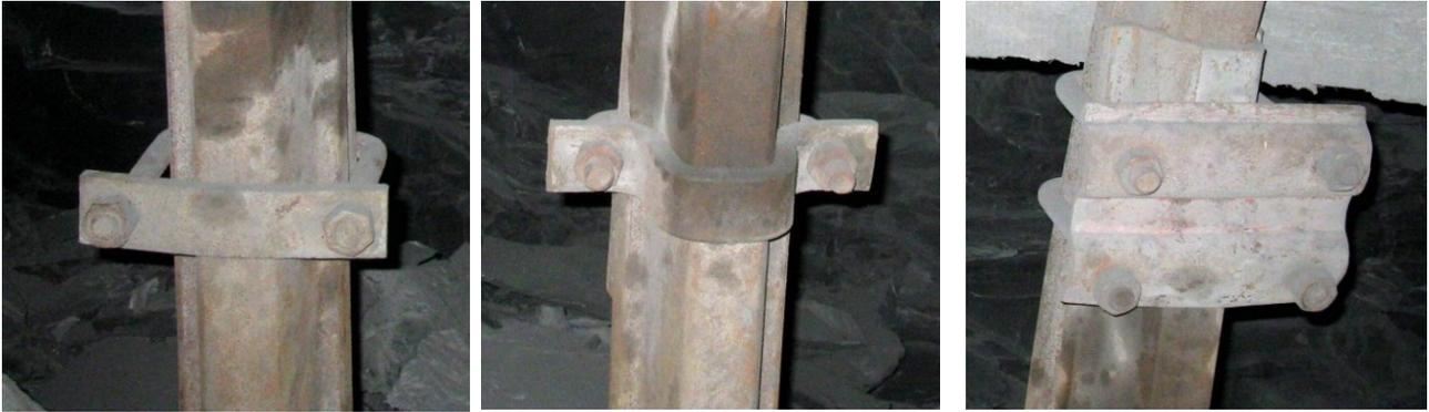
*Рис. 1. Применение хомутов и планок различных типов*
