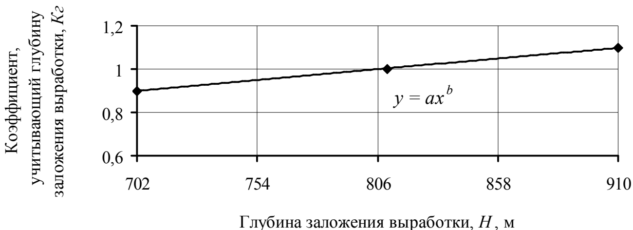
Рис. 2.16. Изменение коэффициента K_2 , учитывающего глубину заложения подэтажной выработки H
