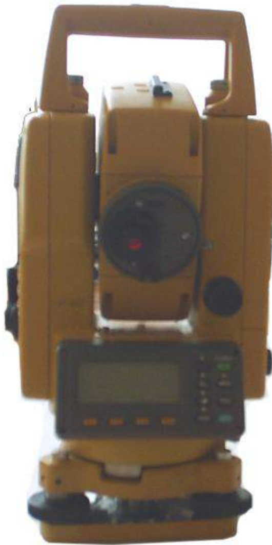
Рис. 3.6. Общий вид безотражательного электронного тахеометра серии GPT – 3000
