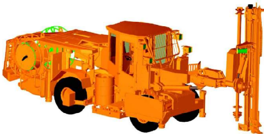
Рис. 8.29. Общий вид установки для крепления анкерами Robolt 7-3 Cabin
