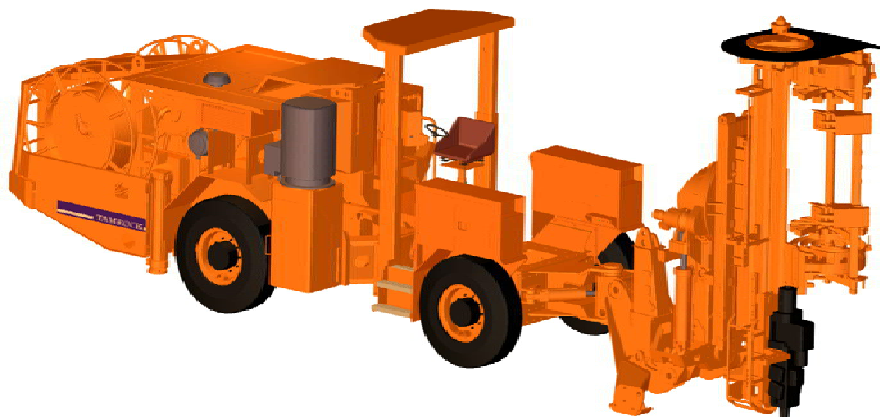
Рис. 3.37. Общий вид бурового станка Solo 7-10C
