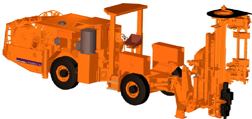
Рис. 3.40. Общий вид бурового станка Solo 7-15C
