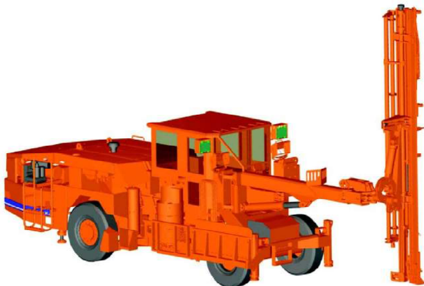
Рис. 8.31. Общий вид установки для крепления анкерами Robolt 08-3 Cabin
