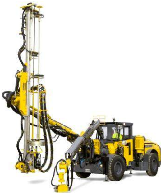
Рис. 8.13. Общий вид установки для крепления анкерами Boltec LD
