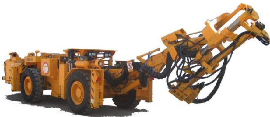
Рис. 8.45. Общий вид установки для крепления анкерами SWK-1HS
