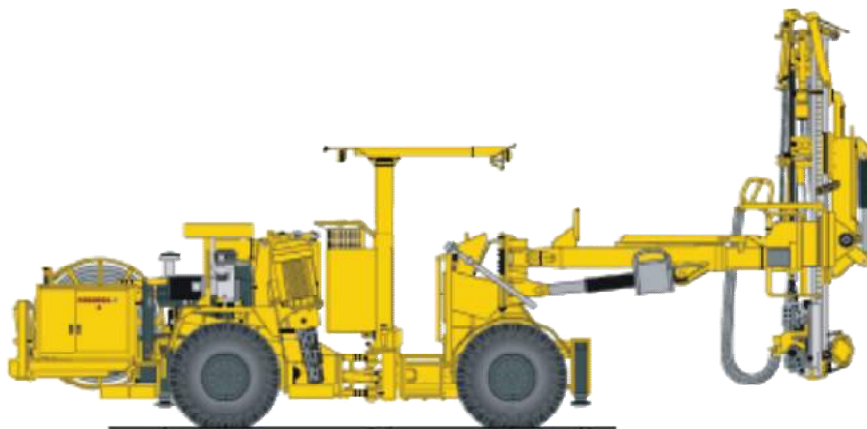
Рис. 8.11. Общий вид установки для крепления анкерами Boltec 235H-DCS
