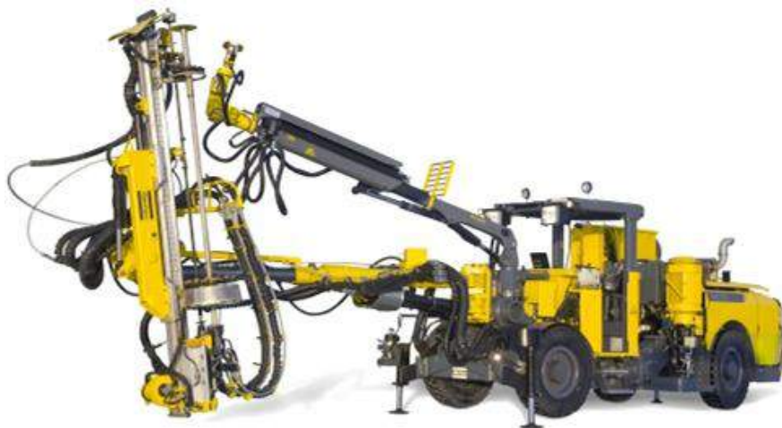
Рис. 8.14. Общий вид установки для крепления анкерами Voltec MC
