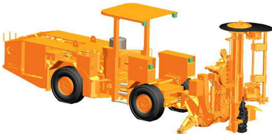
Рис. 3.24. Общий вид бурового станка Solo 5-5C
