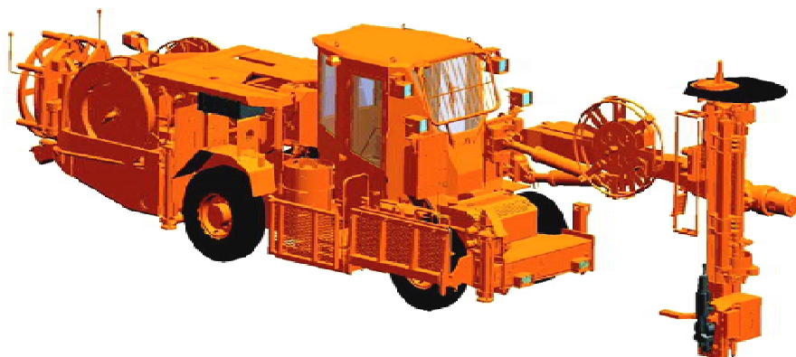
Рис. 8.33. Общий вид установки для крепления тросовыми анкерами Cabolt 7-5 Cabin
