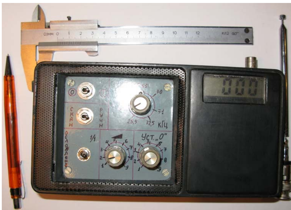
Рис. 3 Внешний вид простейшего индикатора напряженности электромагнитного поля при отключенной антенне
