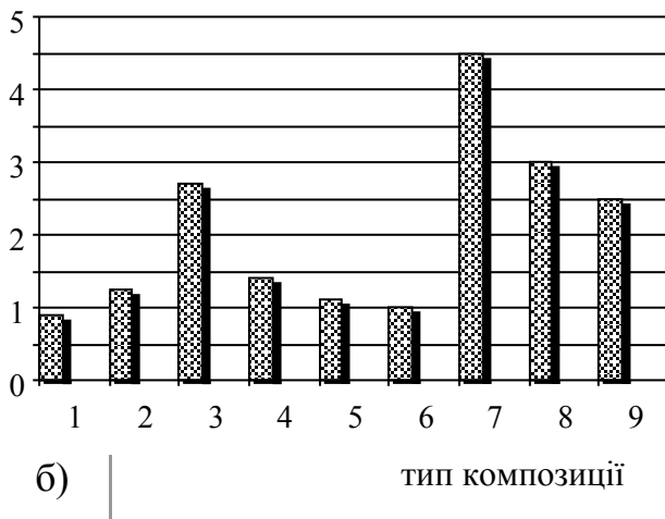
Рис. 2. Ефективність знепилювання бентонітовими композиціями (а) та механічна міцність бентонітових покриттів (б).
