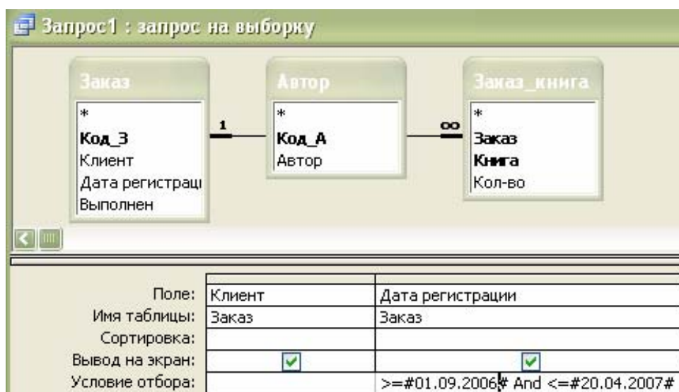
Рисунок 2.7. Для поля Дата реєстрації в бланку запити вказано дві умови, об'єднані оператором And
